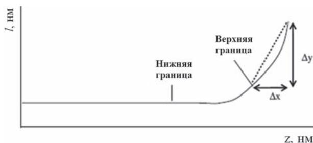
**Рисунок 4** — Процедура первоначальной оценки жесткости материала по наклону секущей (адаптирован из [16])
